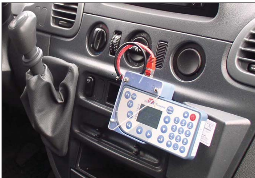
Der Timeboy zur mobilen Datenerfassung lässt sich mit Hilfe des Fahrzeugdatenloggers und optional über GPS auch im Auto einsetzen und dann vor Ort mit auf die Baustelle nehmen
