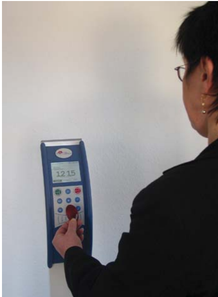
Das Gerät PZE-MasterIV erfasst die Kommt/Geht-Buchungen und zeigt die Salden an
