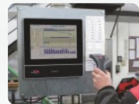
Betriebsdatenerfassung mit externem Barcodescanner. Production data collection with external bar code reader.
