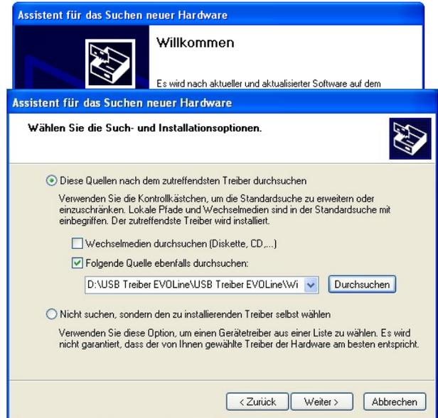
Installation der Treiber für den virtuellen COM Port. Bei diesem Installationsschritt erhalten Sie die Meldung, dass der Treiber den Microsoft Logo-Test nicht bestanden hat. Hier müssen Sie auf „Installation fortsetzen“ klicken, um den Treiber nutzen zu können.
