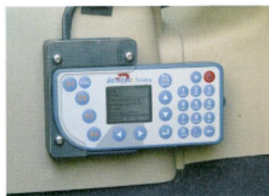
Automatische Zeit- und Routenerfassung: Mit dem Timeboy schalten die Mitarbeiter das Fahrzeug frei und GPS aktiv ...
