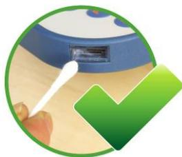
Hin und wieder ist eine Reinigung des Laserscannerfensters notwendig, um die einwandfreie Funktion zu erhalten. Verwenden Sie dazu Wattestäbchen und Wasser oder einen milden Reiniger (keine Scheuermilch oder ätzende Reiniger) und säubern Sie damit das Fenster. Keinesfalls dürfen spitze Gegenstände zum Säubern verwendet werden, da das Laserscanner-Fenster dadurch zerkratzt wird und dies die Funktionstüchtigkeit des Lasers beeinträchtigt.
