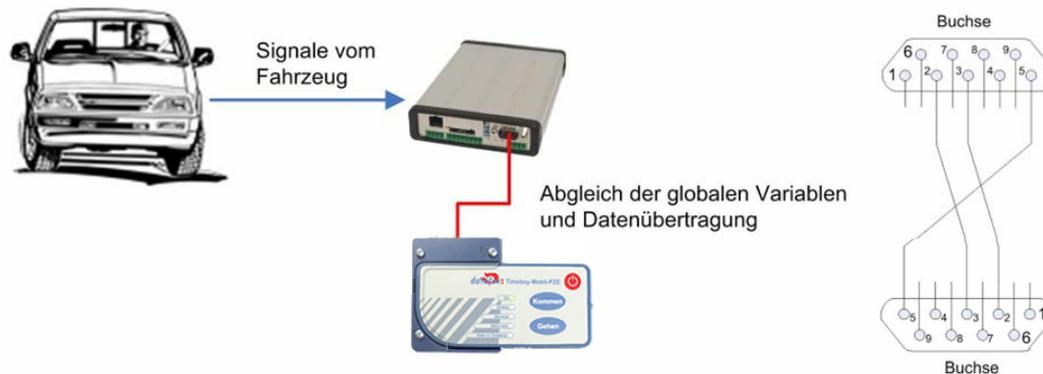
Bei Erfassung der Fahrzeugdaten besteht generell das Problem der Zuordnung zu Personen, Aufträgen, etc. Befindet sich ein Timeboy in der Fahrzeugdockingstation, können die Fahrzeugdaten zeitnah in den Timeboy übertragen werden. Das Problem besteht, wenn sich während der Fahrt kein Timeboy in der Dockingstation befindet.
