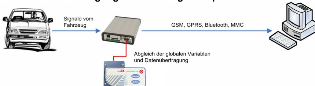
Der Mobil-MasterIV pollt auf die Mobildockingstation und prüft bei eingestecktem Timeboy, ob Datensätze im Timeboy vorliegen. Wenn im Timeboy Datensätze existieren, werden diese auf den Mobil-MasterIV übertragen und anschließend durch diesen an den PC gesendet. Die Fahrzeugdaten werden ebenfalls vom Mobil-MasterIV auf den PC übertragen.
