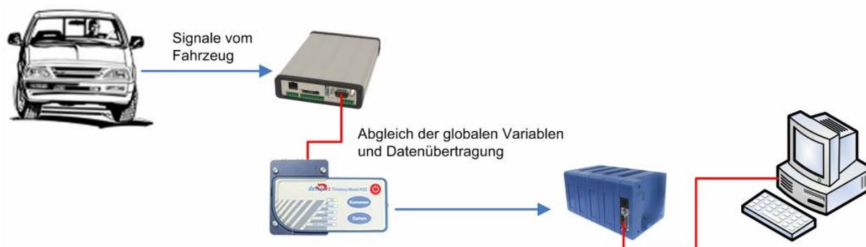
Alle Fahrzeugdaten werden durch den Mobil-MasterIV auf den Timeboy übertragen. Der Timeboy, dient in diesem Fall als Datenübertragungsmedium. Mit einer normalen Dockingstation, keine Mobildockingstation, werden anschließend alle Daten vom Timeboy auf den PC übertragen.
