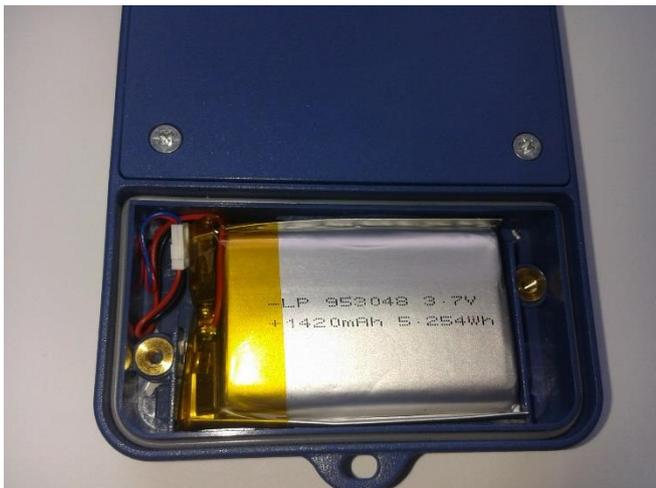
Bei der Auslieferung des TBIV mit Lithium Polymer Akkus ist dieser nicht angeschlossen. Zur Inbetriebnahme ist der Akku mittels der Steckverbindung mit dem Gerät zu verbinden, anschließend im Akkufach zu verstauen und das Kabel mit dem Steckverbinder wie links dargestellt zu verstauen.
