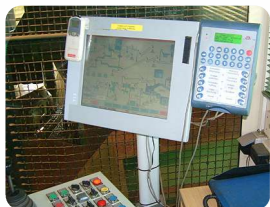
Maschinendatenerfassung mit dem Datafox AE III+. Machine data collection with the Datafox AEIII+.
