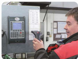
Betriebsdatenerfassung mit externem Barcode-Leser. Production data collection with external bar code reader.
