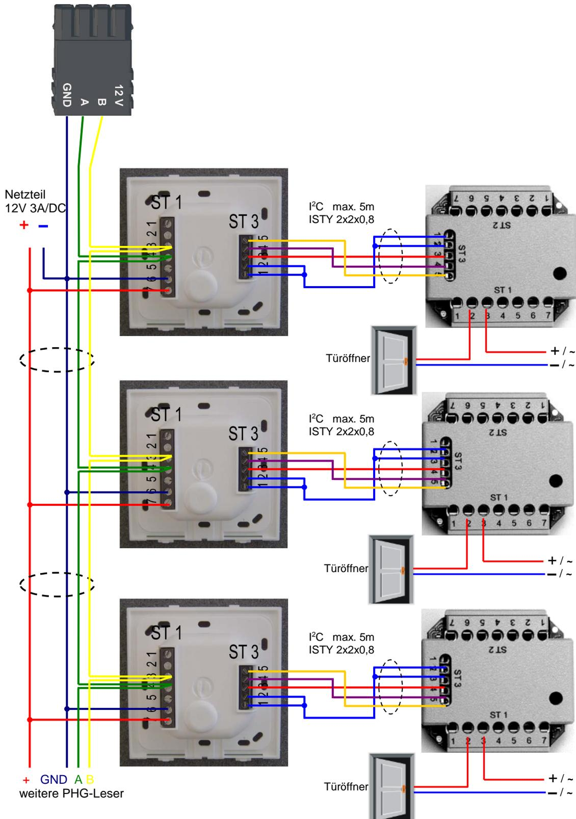
Bei dem Anschluss des Türöffners sollte unbedingt eine Schutzschaltung integriert werden.
