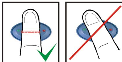
3.) Den Finger mit etwas Druck auf den Scanner flach über den Scanner ziehen.
