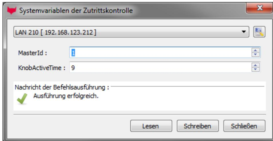
Master ID ist im Bereich von 1 bis 9999 setzbar. Besitzt ein Gerät mehr als einen ZK Bus, so ist die ZK-Master ID die ID des ersten Busses. Der zweite Bus ZK-Master ID + 1 usw.
