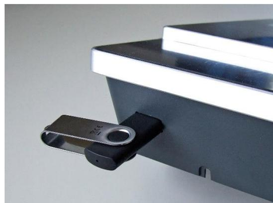
Der USB- Stick wird automatisch erkannt. Hierzu muss die Hauptkommunikation auf USB-Host stehen. Sie sehen die direkt im Display an diesem Symbol (Icon)
