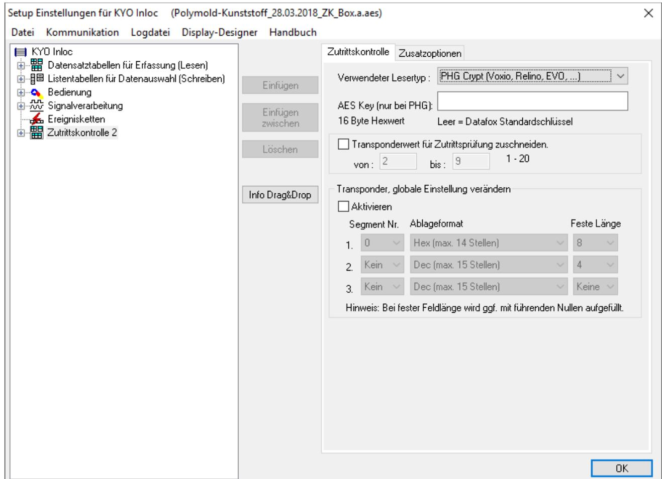
Ist unter „AES Key (nur bei PHG)“ kein Schlüssel eingetragen, so wird ein Standardschlüssel verwendet.
