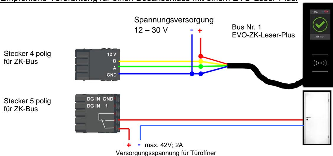
Alternativ kann bei der Verwendung von **nur einem Leser** dieser an die Spannungsversorgung des RS485 Moduls aus dem Master genutzt werden.
