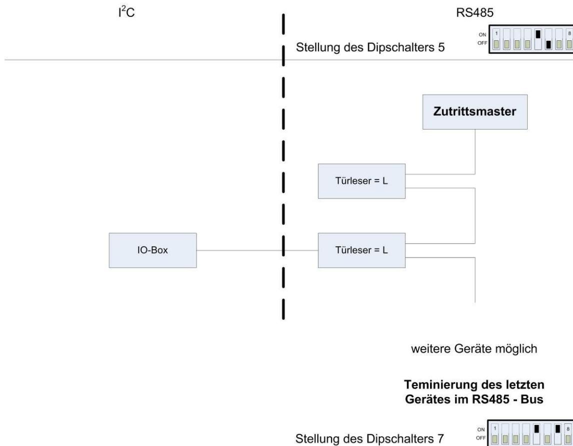
Über die Dip-Schalter 1-4 wird die Bus-Nummer des Moduls eingestellt. Der Dip-Schalter 5 muss immer auf „ON“ gesetzt werden. Die Dip-Schalter 6 und 8 müssen immer auf „OFF“ stehen. Mit dem Dip-Schalter 7 = „ON“ wird am letzten Modul der RS485-Bus terminiert (120 Ω Abschlusswiderstand), sonst immer „OFF“.
