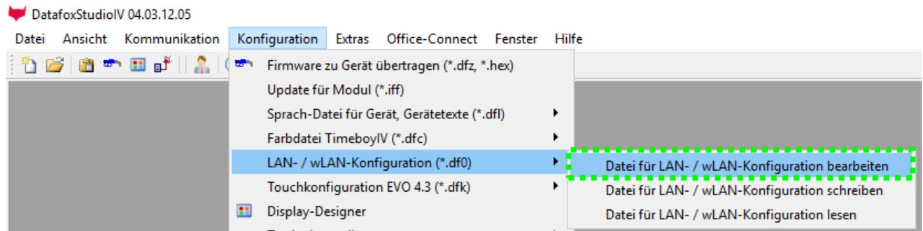
Die LAN / WLAN Konfigurationen werden in einer Datei mit der Endung „\*.df0“ abgelegt. Hier haben Sie nun die Möglichkeit die Datei zu bearbeiten, in das Datafox-Gerät zu laden (hochladen) oder aus dem Gerät zu lesen (runterladen). Beim Lesen der WLAN Einstellung aus dem Gerät wird die aktuell angegebene Datei überschrieben.
