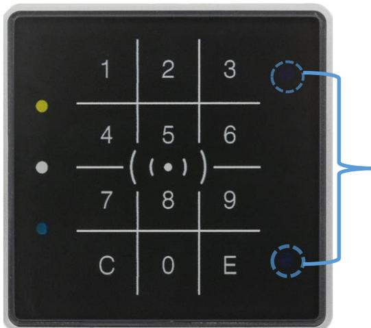
Der Näherungssensor befindet sich am rechten Rand: Die Einstellung erfolgt über das DatafoxStudioIV unter Konfiguration -> Näherungssensor:
