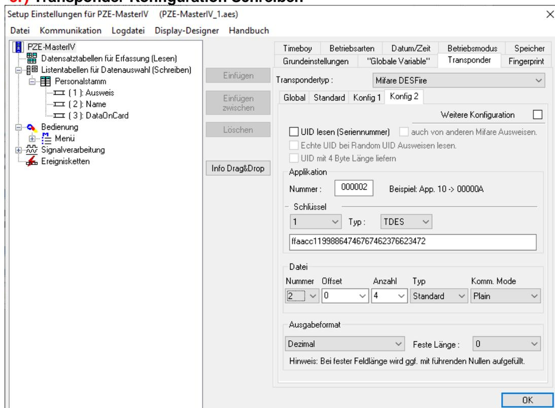
Die Transponderkonfiguration für das Schreiben kann frei gewählt werden, sie muss aber zuvor in den Transpondergrundeinstellungen definiert worden sein.
