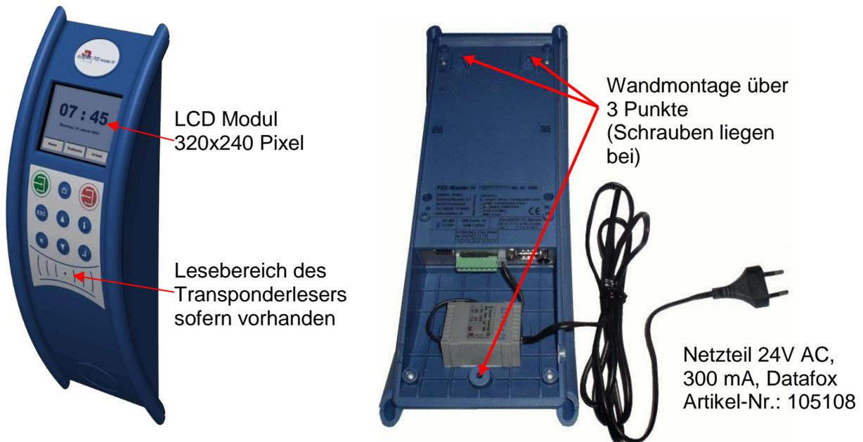
Wenn das Gerät auf eine Unterputzdose montiert wird und dort nur eine Schraubklemme zur Verfügung steht, schneiden Sie einfach den 230 Volt Stecker ab und schließen Sie die Adern an die Schraubklemme an.
