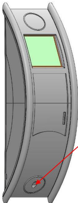
Zuletzt mit der Linsen – Flanschkopfschraube den PZE-Master unten befestigen und den Logoaufkleber anbringen.
