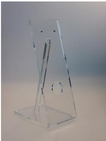
Führen Sie die Stütze in die beiden dafür vorgesehenen Öffnungen im Boden und der Montageebene ein. Anschließend hängen Sie das Gerät in die beiden vormontierten Schrauben ein. Zum Verlegen der Anschlußleitungen dient die kreisrunde Öffnung.
