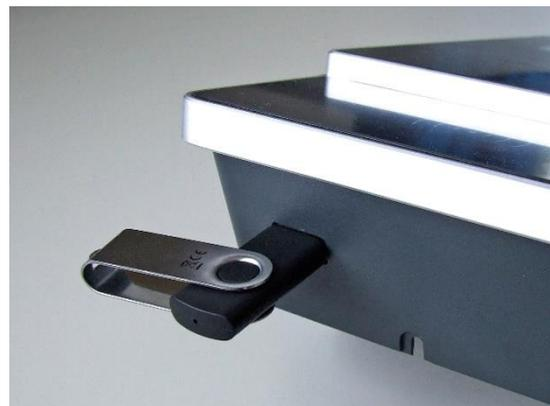
Der USB- Stick wird automatisch erkannt. Hierzu muss die Hauptkommunikation auf USB-Host stehen. Sie sehen die direkt im Display an diesem Symbol (Icon)
