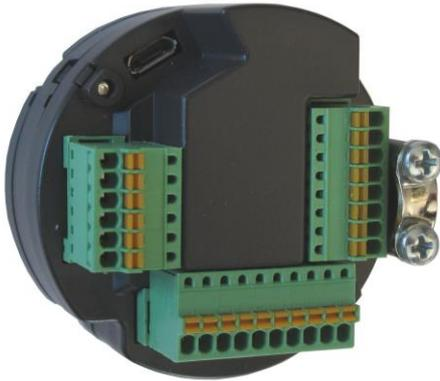
Der KYO Oneloc CWR ist ein Wiegand Konverter, mit dem ein Wiegand Zutrittsleser an einen Datafox Zutrittscontroller mit RS485-Bus angeschlossen werden kann.
