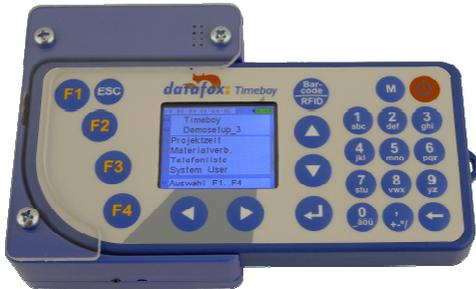
Bei der Auslieferung wird das Gerät mit einem Demosetup versehen. Die Firmware ist die Aktuellste, wenn nicht anders gewünscht. Zur Anzeige der Firmwareversion wählen Sie den Menüpunkt System ( Systemmenü ). Die Firmwareversion und das Datum der Version werden in der K1-Zeile angezeigt. Zum Verlassen des Systemmenüs betätigen sie die ESC-Taste.
