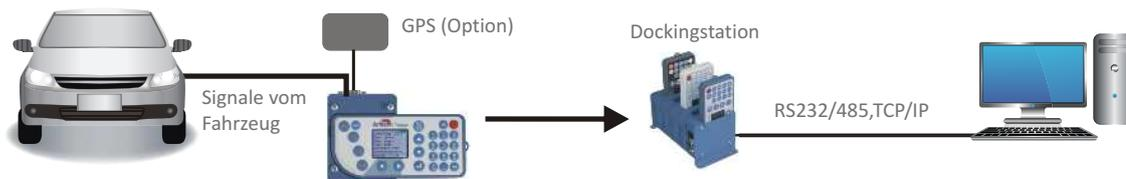
Der Fahrzeugdatenlogger erfasst die Fahrzeugdaten mit Start, Stop und Entfernungsimpulsen und speichert jede Fahrtbewegung mit Datum und Uhrzeit. Die Daten aus dem Fahrzeugdatenlogger werden in den Timeboy übertragen. Über den Timeboy werden auch die Zeit- und Auftragsbuchungen durchgeführt. Alle Daten werden im Betrieb über eine Dockingstation aus dem Timeboy ausgelesen.
