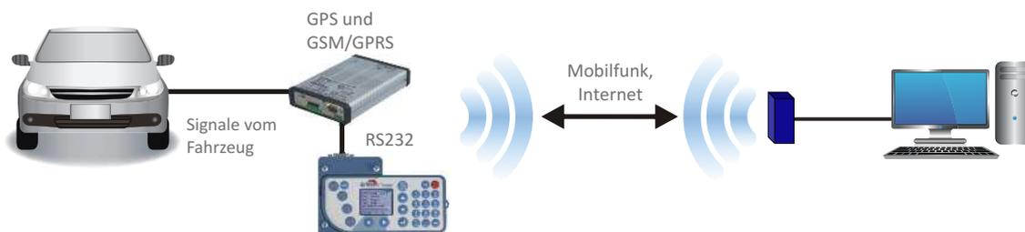
Der Mobil-MasterIV erfasst die Fahrzeugdaten mit Start, Stop und Entfernungsimpulsen und speichert jede Fahrtbewegung mit Datum und Uhrzeit. Die Daten werden vom Mobil-MasterIV sofort an die Zentrale übertragen. Über den Timeboy werden auch die Zeit- und Auftragsbuchungen durchgeführt. Der Mobil-MasterIV liest den Timeboy über die Mobil-Dockingstation aus und überträgt auch diese Daten an die Zentrale.
