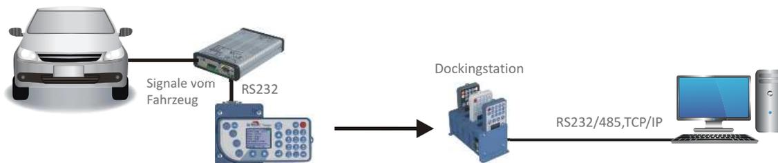
Der Mobil-MasterIV erfasst die Fahrzeugdaten mit Start, Stop und Entfernungsimpulsen und speichert jede Fahrtbewegung mit Datum und Uhrzeit. Die Daten aus dem Mobil-MasterIV werden in den Timeboy übertragen. Über den Timeboy werden auch die Zeit- und Auftragsbuchungen durchgeführt. Alle Daten werden im Betrieb über eine Dockingstation aus dem Timeboy ausgelesen.
