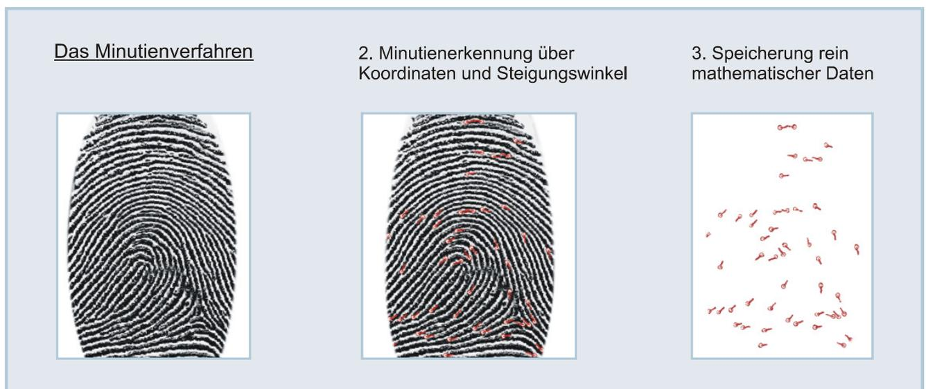
Sowohl beim Einlernen der Referenzfinger (Enrollment) als auch bei der Überprüfung am Terminal (Matching) wird dieses Minutienverfahren verwendet. Die beim Enrollment erstellten Datensätze werden als Mastertemplates auf dem Leser-Modul Biokey3000 im Terminal abgelegt. Hier stehen sie als Referenz für das Matching zur Verfügung. Wird beim Buchen am Terminal eine Übereinstimmung der Datensätze festgestellt, ist die Person eindeutig identifiziert.
