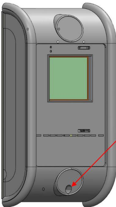
Zuletzt mit der Linse-Flanschkopf-Schraube den AE-Master unten befestigen und den Logoaufkleber anbringen.
